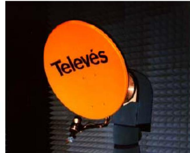
El eje del alimentador coincide con la dirección  $\psi_0$ , y para conseguir máxima ganancia debe iluminar el borde de la apertura típicamente a  $-10$  dB
